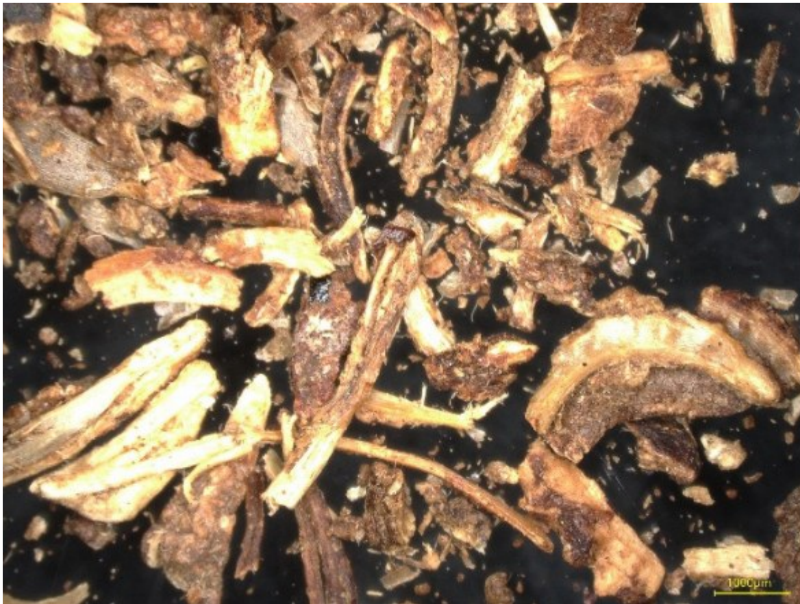
Figuur: microscopische observatie van vezelachtige zaadresten van Calendula officinalis na hexaanextractie, beschikbaar als biomassa voor functionele coatingtoepassingen (© Sirris).
