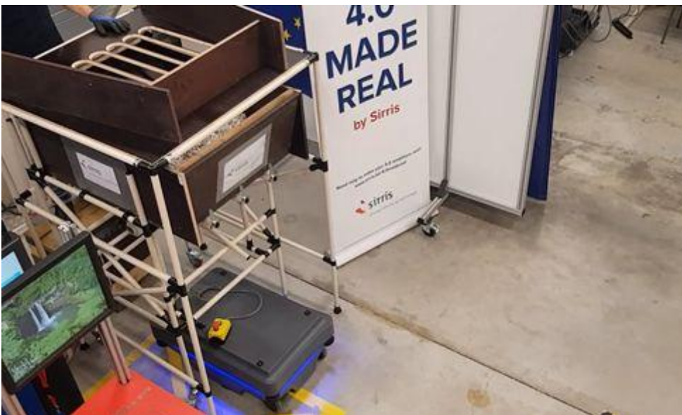
Test met AGV en onze karakuri-kaizen-kar (Bron: Sirris)
